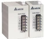
Серия DVPPS специально разработана для питания контроллеров DVP с установкой на стандартную 35-мм DIN-рейку. Она проста в монтаже и подключении к контроллерам. Блоки питания DVPPS в настоящее время выпускаются с номинальным выходным напряжением 24 В и мощностями 24 Вт, 48 Вт и 120 Вт (вых. ток 1А, 2А и 5А соответственно).
